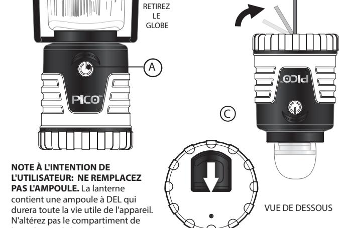
**NOTE À L'INTENTION DE L'UTILISATEUR: NE REMPLACEZ PAS L'AMPOULE.** La lanterne contient une ampoule à DEL qui durera toute la vie utile de l'appareil. N'altérez pas le compartiment de l'enveloppe de l'ampoule DEL (globe intérieur). La lanterne pourrait être endommagée de façon irréversible ou de l'humidité pourrait s'infiltrer dans l'ampoule.
