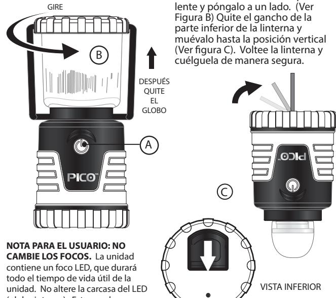
**NOTA PARA EL USUARIO: NO CAMBIE LOS FOCOS.** La unidad contiene un foco LED, que durará todo el tiempo de vida útil de la unidad. No altere la carcasa del LED (globo interno). Esto puede ocasionar daño permanente a la linterna o humedad dentro del bulbo.
