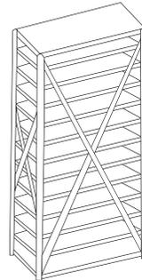
1. Poser deux postes sur le sol ou une table. Assurez-vous que les messages sont parallèles et espacés d'une profondeur de plateau à part. Petits côtés des poteaux doivent faire face vers l'avant et le côté arrière de l'unité d'étagère.
